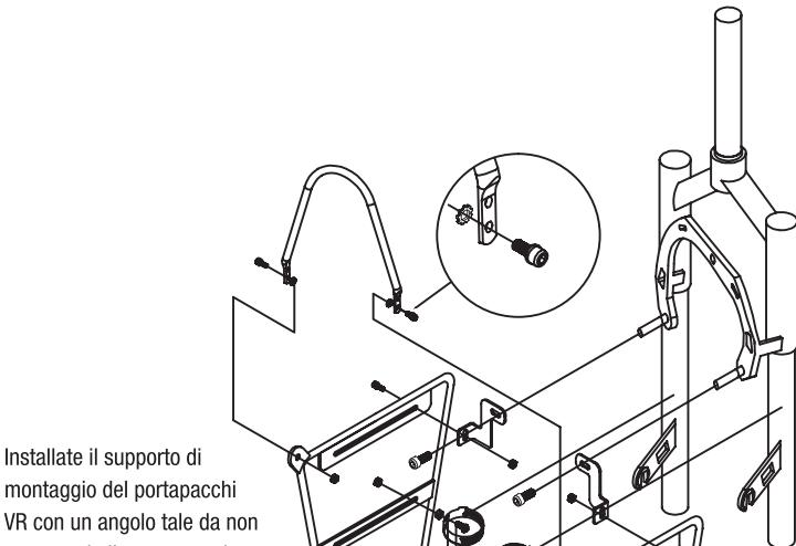
Installate il supporto di montaggio del portapacchi VR con un angolo tale da non superare la linea tratteggiata del disegno.
