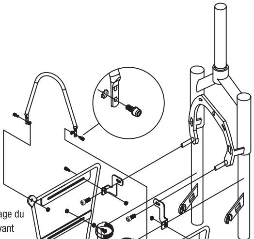
Montez le support de montage du porte-bagages pour roue avant dans un angle qui ne dépasse pas la ligne en pointillé du dessin.
