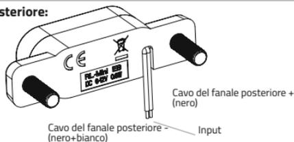
**Fissaggio della luce posteriore:**
